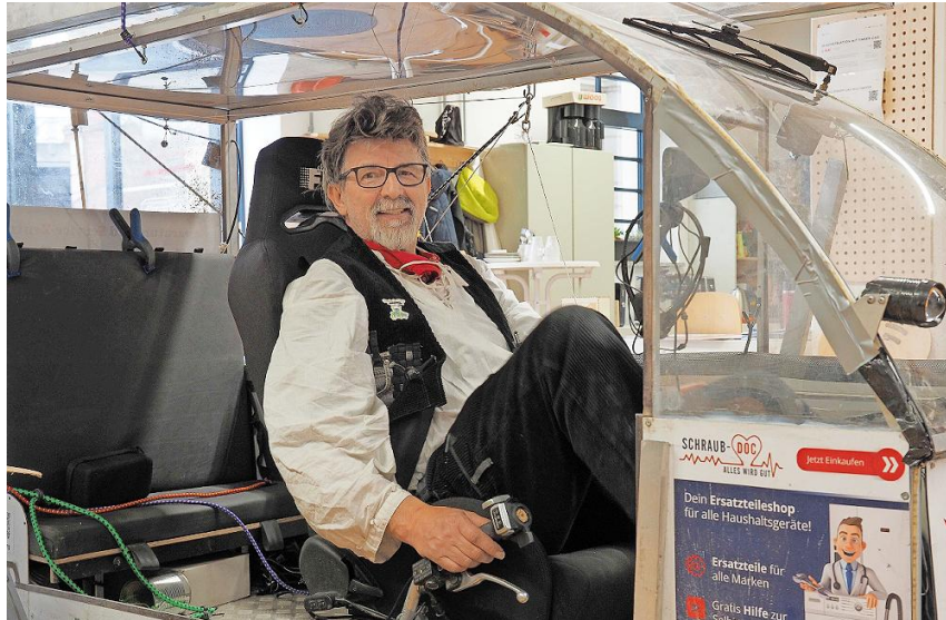
Die Geschwindigkeit des Vollkabinen-Fahrrads steuert Michael Heftrich über einen Handregler. Der Elektromotor unterstützt, bis das Fahrzeug 25 Stundenkilometer schnell fährt.
